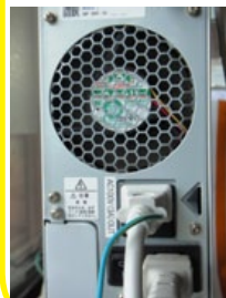
排気口に八ニカム形状を採用。優れた通気性が得られ排気能力が向上。
